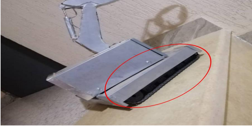
الشكل 4 ( آلية الحركة للروبوت )
