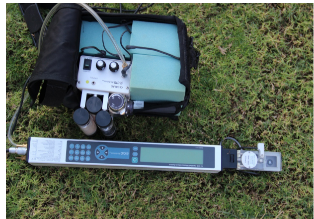
شكل 1. جهاز محمول لتحليل بيانات بالموجات تحت الحمراء لقياس نشاط التمثيل الضوئي وعملية النتح.
