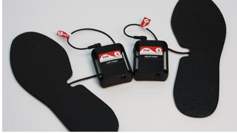
صورة توضح جهاز قياس رد ضغط القدمين biosyn system
