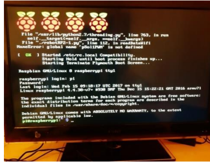
شكل (3) واجهة موجه الأوامر لكتابة وتنفيذ الأكواد في لوحة راسبري باي
