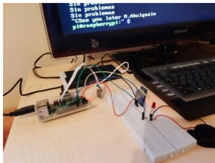
شكل (7) التنفيذ الفعلي لدائرة حساس الغاز
