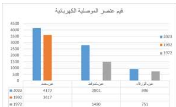
شكل 5. نتائج مقارنة تحليل الكيمياء للتوصيل الكهربائي Ec
